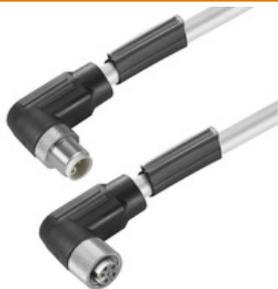
Вашим периферийным устройствам требуется питание большей мощности. С нашим новым вставным разъемом M12 можно обеспечить питание более 250 В и 2 А без всяких проблем. Компактные вставные разъемы M12 с S- и T-кодировкой предназначены для передачи напряжения до 630 В перем. тока или 60 В пост. тока при силе тока до 12 А.
